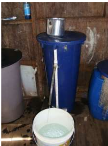
Figura 7. Filtro com sistema de filtração por areia
