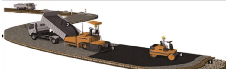
Figura 1: Etapas da Pavimentação
