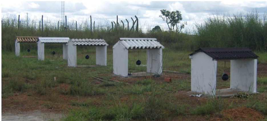
Figura 1. Modelos reduzidos com as respectivas coberturas instaladas.
