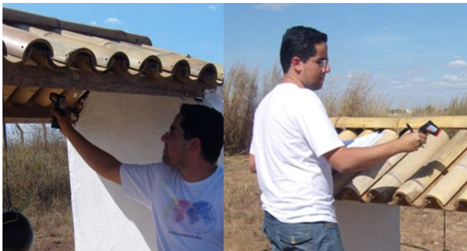
Figura 3 – Coleta da temperatura da superfície interna e externa das coberturas
