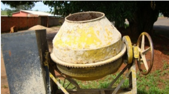
Figura 04. betoneira encima do canteiro. YI:692996 XI:8147768. Fonte: Tayná
