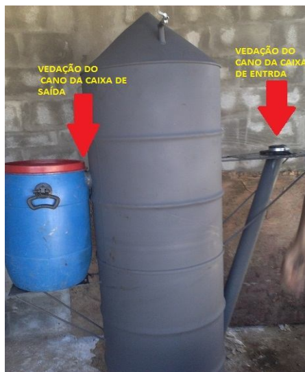
Figura 02 - Biodigestor Piloto. Fonte: Winderson /2011.
