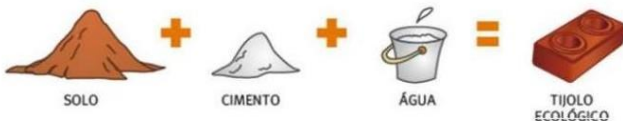
Figura 3: Processo fabricação Solo-cimento.
