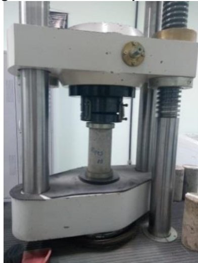
Figura 6 – Ensaio compressão axial
