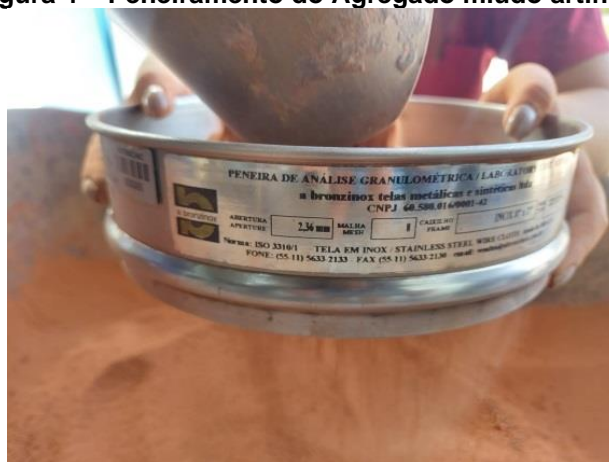
Figura 4 – Peneiramento do Agregado miúdo artificial
