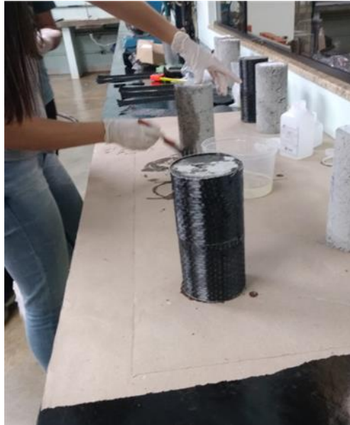
Figura 5 - Aplicação da fibra de carbono
