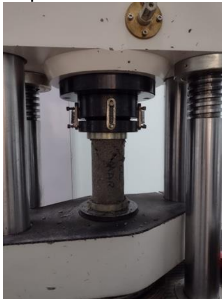
Figura 7 - Rompimento do corpo de prova sem fibra de carbono
