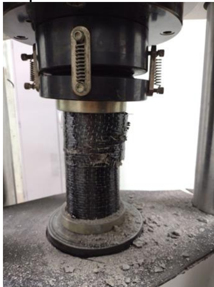
Figura 8 - Rompimento do corpo de prova com fibra de carbono
