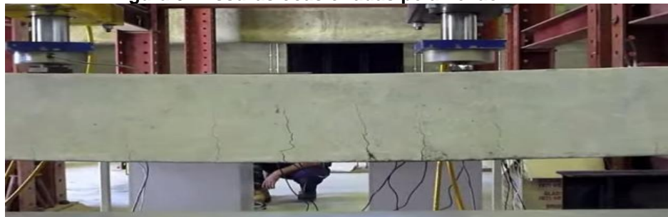
Figura 5- Fissuras ocasionadas pela flexão
