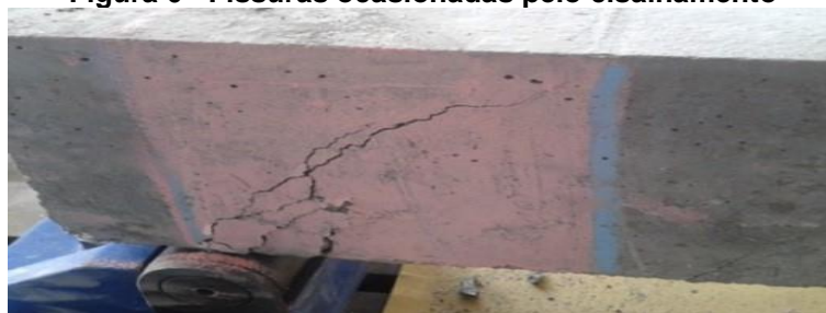
Figura 6 - Fissuras ocasionadas pelo cisalhamento
