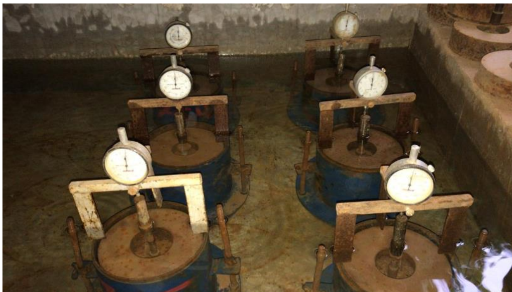
Figura 9 – Corpos de prova submersos para expansão
