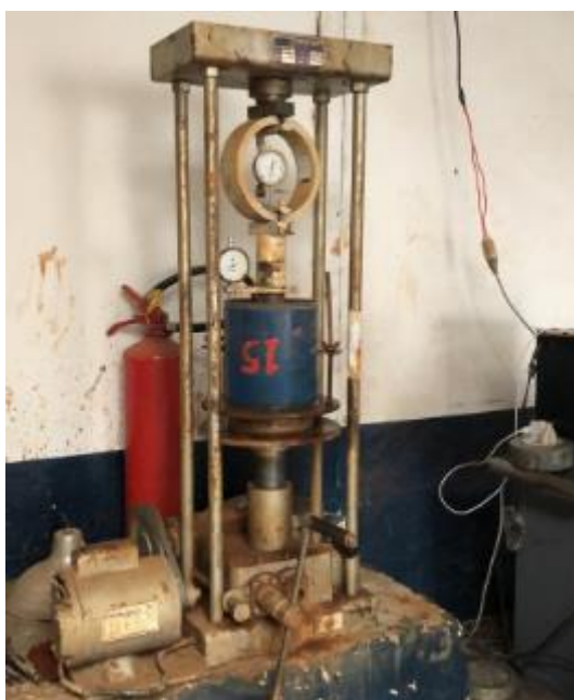
Figura 10 – Perfuração do corpo de prova na prensa de ISC
