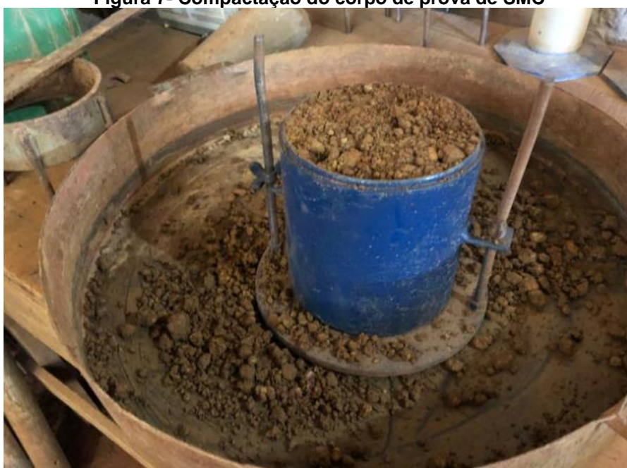
Figura 7- Compactação do corpo de prova de SMC
