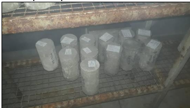
Figura 9: Corpos de prova na fase de cura na câmara úmida
