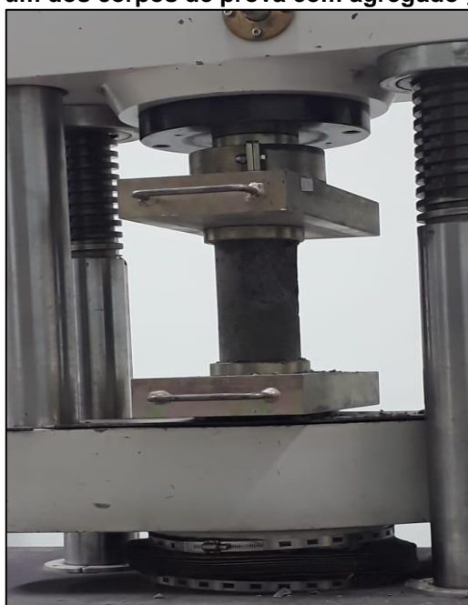
Figura 10: Prensa rompendo um dos corpos de prova com agregado graúdo da Pedreira B
