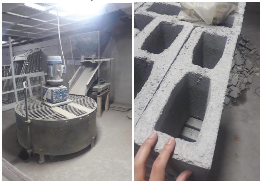
Figura 2- (a) Misturador e balança; (b) Blocos finalizados e paletizados, prontos para o uso na obra
