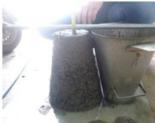
Figura 5- Abatimento do concreto
