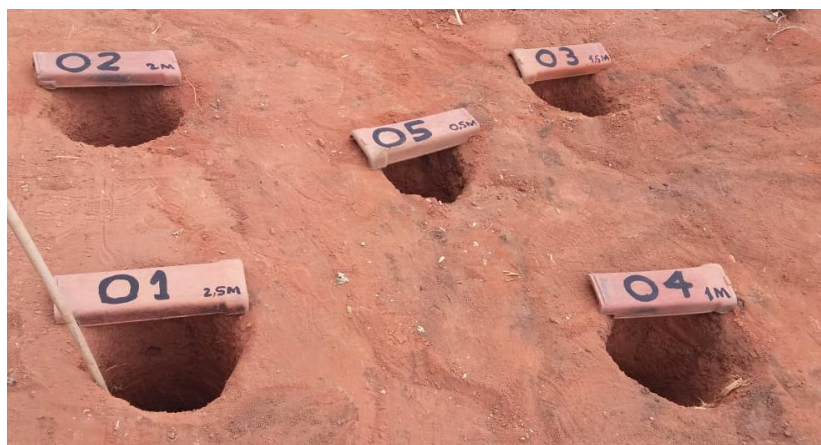
Figura 2 - Furos para aferição de temperatura
