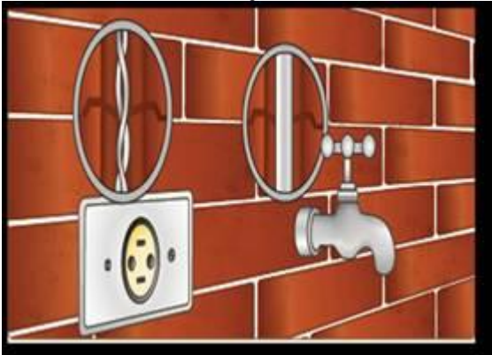
Figura 3 - Ilustração de aplicação de dutos em tijolos
