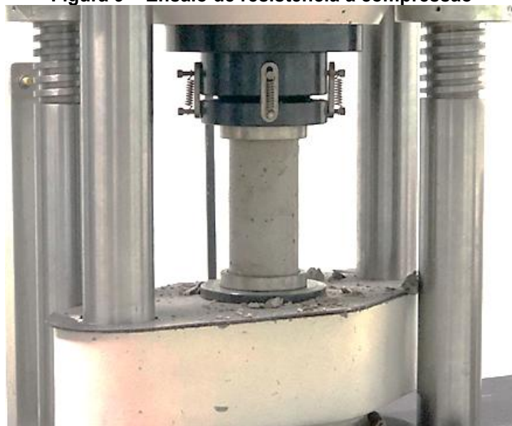
Figura 9 – Ensaio de resistência à compressão
