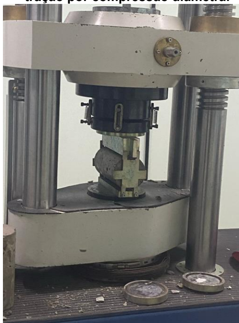
Figura 10 – Ensaio de resistência à tração por compressão diametral
