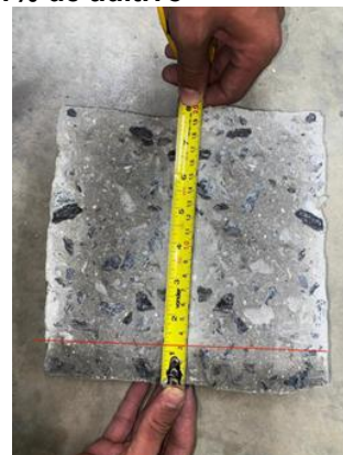
Figura 13 – Altura da água absorvida nos corpos de prova sem e com 1% de aditivo
