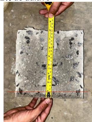
Figura 14 – Altura da água absorvida nos corpos de prova com 1,5% e 2% de aditivo
