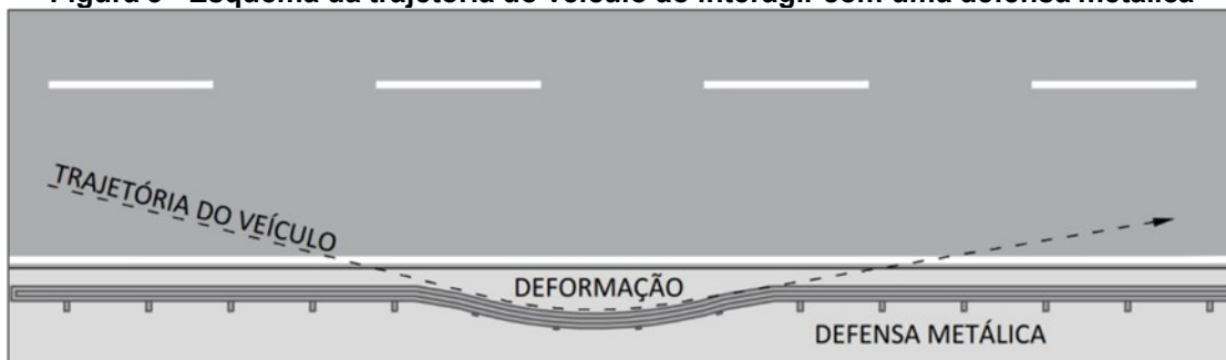
Figura 3 - Esquema da trajetória do veículo ao interagir com uma defesa metálica
