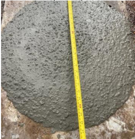
Figura 10 - Flow Test: Traço sem Nanossílica (675 mm)
