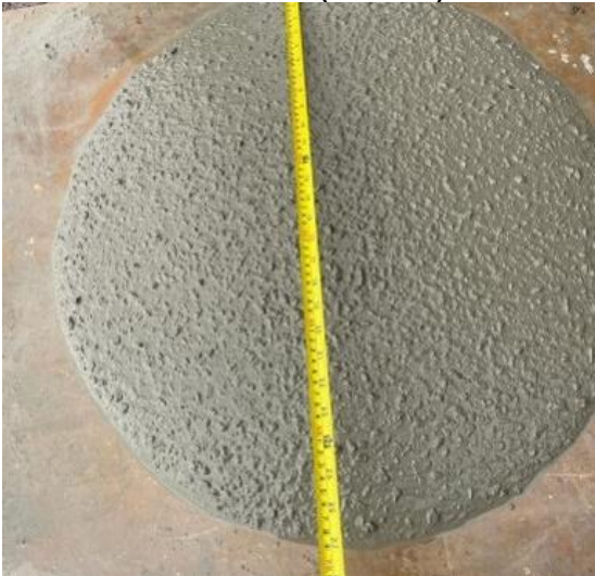
Figura 9 - Flow Test: Traço com Nanossílica (690 mm)
