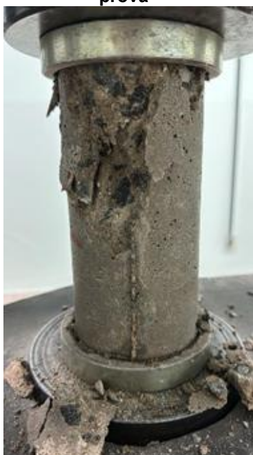
Figura 6 – Ruptura do corpo de prova
