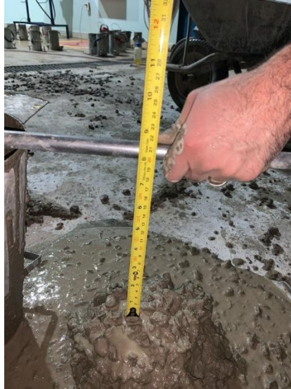
Figura 2 – Teste de abatimento do tronco de cone
