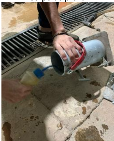
Figura 3 – Untando molde do corpo de prova
