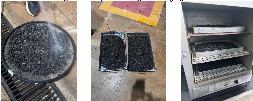
Figura 3 - Limpeza e secagem dos agregados
