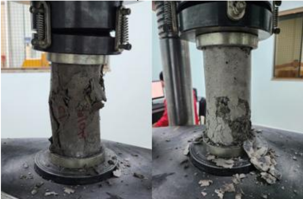
Figura 10 - Rompimento das amostras com e sem as fibras, respectivamente, após 7 dias
