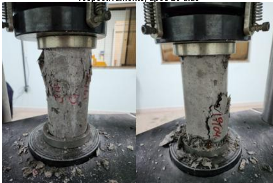
Figura 12 - Rompimento das amostras com e sem as fibras, respectivamente, após 28 dias
