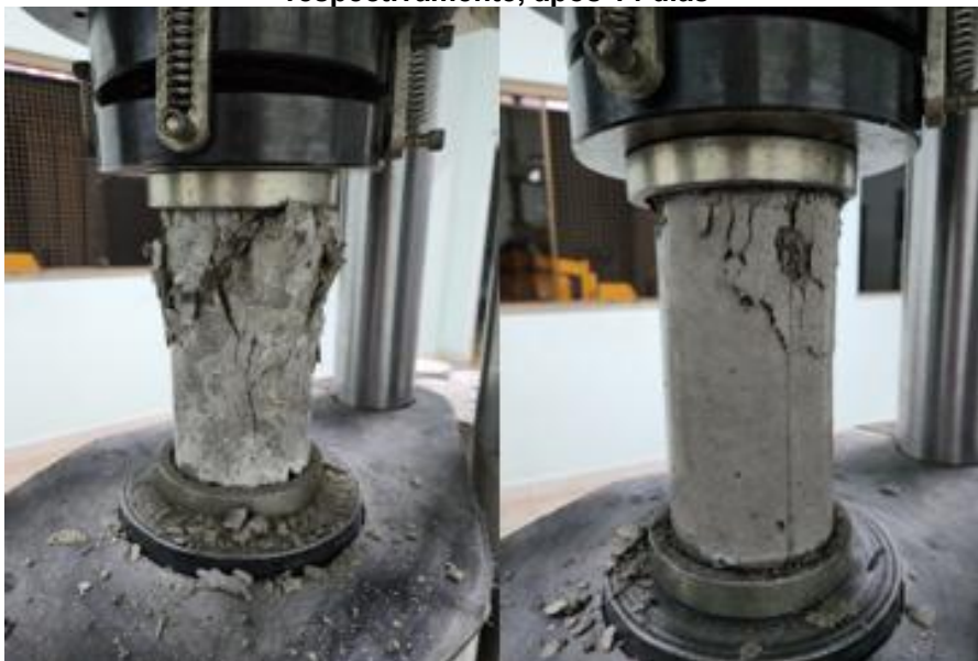
Figura 11 - Rompimento das amostras com e sem as fibras, respectivamente, após 14 dias
