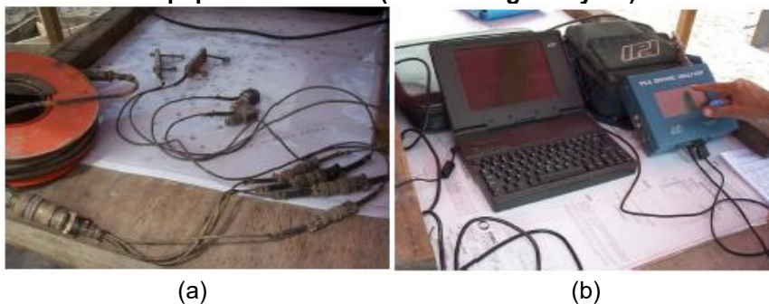
Figura 4 - (a) Transdutores e acelerômetro utilizados no ensaio; (b) equipamento P.D.A. (Pile Driving Analyser)
