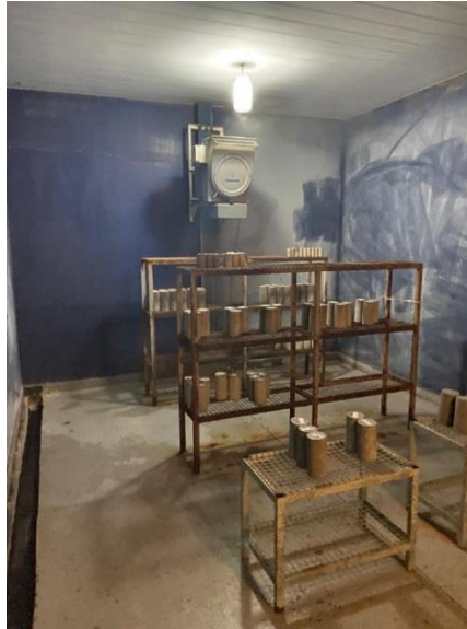
Figura 6 – Câmara úmida para armazenamento dos CP's
