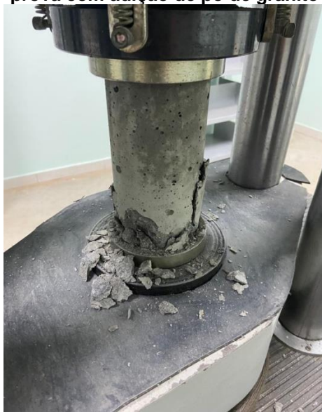
Figura 12 – Ruptura do corpo de prova com adição de pó de granito
