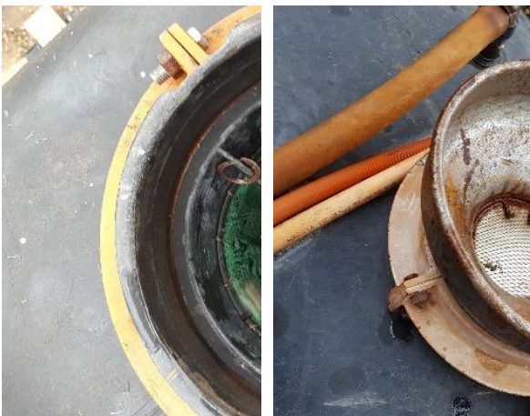
Figura 3 – Adaptações realizadas no filtro do depósito dos pulverizadores inspecionados.
