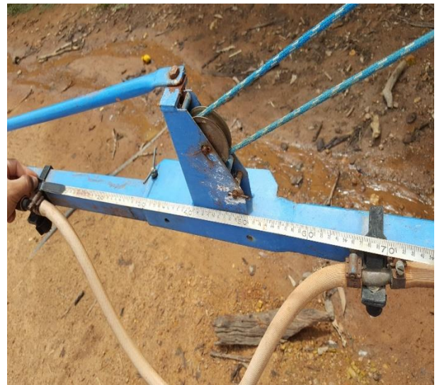
Figura 4 - Desuniformidade no espaçamento do pulverizador hidráulico acoplado, no qual o espaçamento correto seria de 0,50 m.
