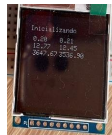
Figura 14. Display com as informações de tensão e corrente.
