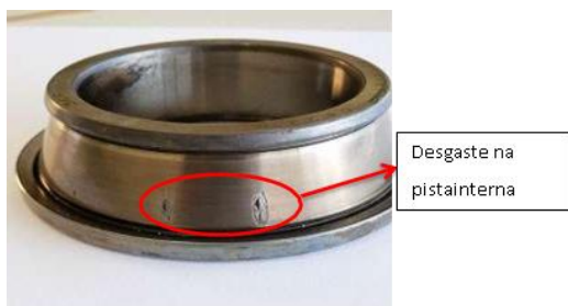
Figura 4 - Rolamento 31312 J2 com Desgaste Superficial.
