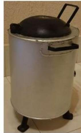
**Figura 2:** Forno do equipamento com isolamento em manta fibra cerâmica.
