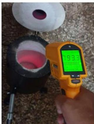
**Figura 3:** Medição de temperatura com 30 minutos de funcionamento.
