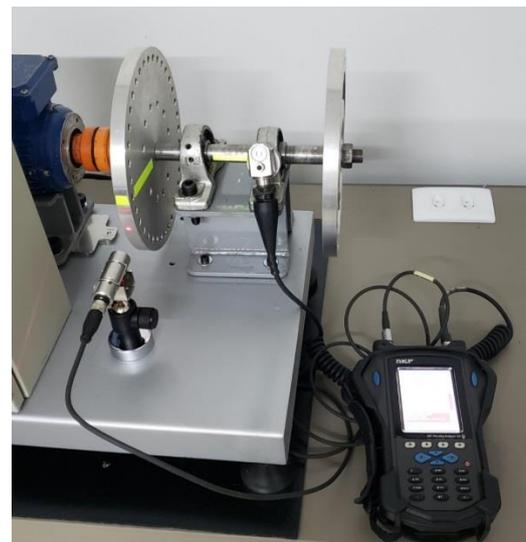
Figura 22 - Equipamentos para balanceamento
