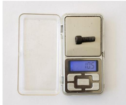
Figura 21 - Balança de precisão
