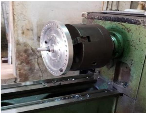
Figura 3 - Usinagem do disco rotor
