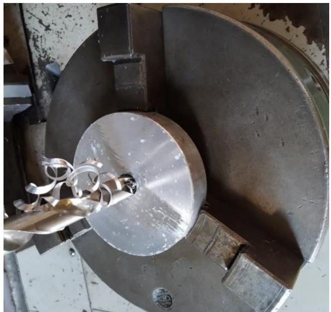
Figura 16 – Acoplamento de alumínio.
