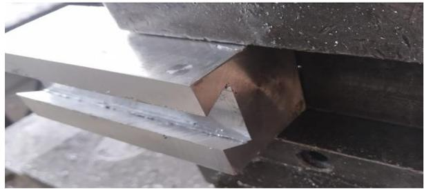
Figura 15 – Fabricação do barramento de deslizamento do cabeçote.
