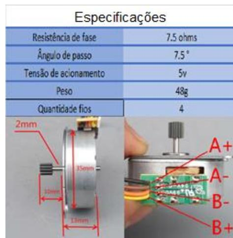
Figura 13 – Especificação do motor de acionamento do cabeçote.
