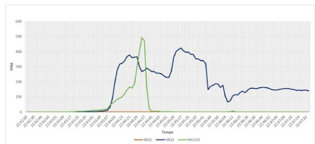
Figura 5 - Teste com álcool - Valores coletados da curva de sensibilidade CO dos sensores
