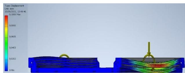
**Figura 17.** Deslocamento eixo Y.
