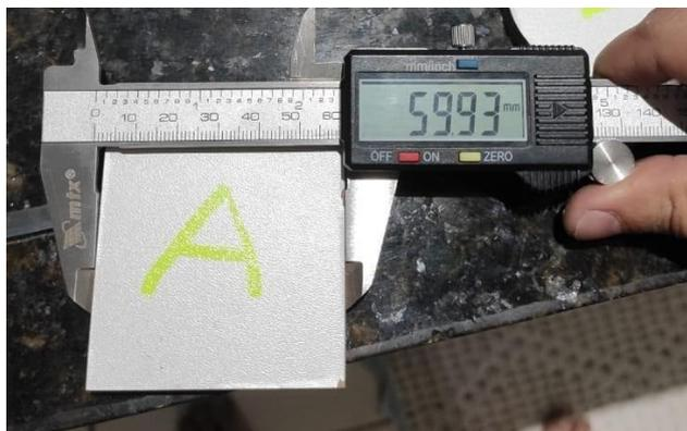
**Figura 24.** Controle dimensional quadrado 60x60mm.
