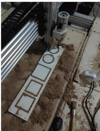
**Figura 23.** Usinagem de corpos de teste.
