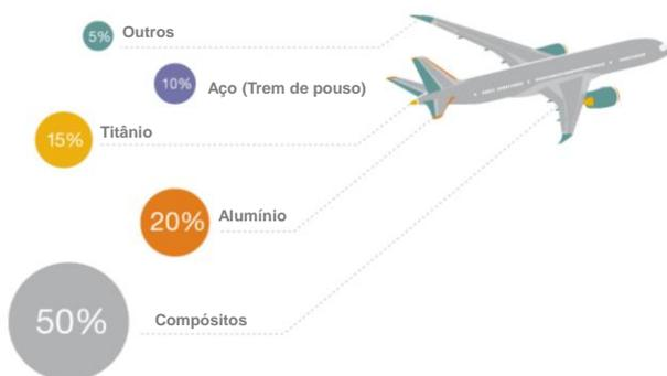
**Figura 3:** Materiais usados na fabricação da aeronave Boeing 787<sup>14</sup>.
