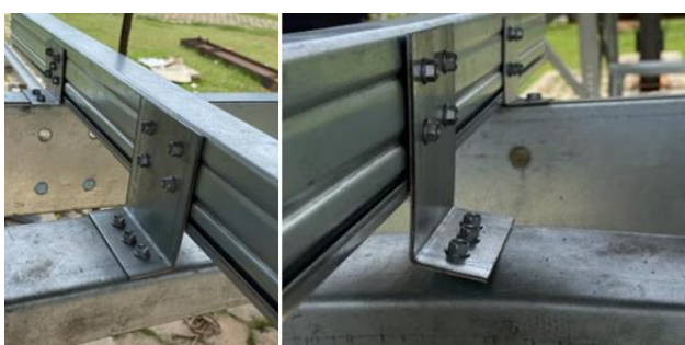
Figura 6 - Ligação da cantoneira (a) antes da realização do ensaio e (b) após o ensaio. [8].
