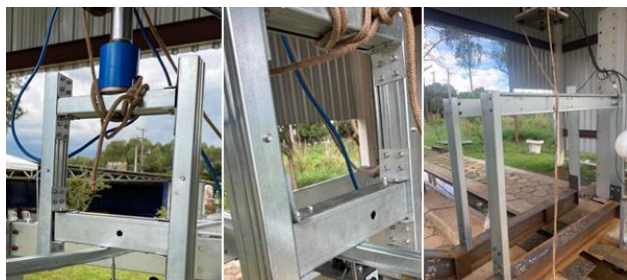
Figura 4 - Dispositivos Auxiliares: (a) Aplicador de Carga – Prensa Hidráulica; (b) Transmissor de Carga; (c) Pórticos de apoio [8].
