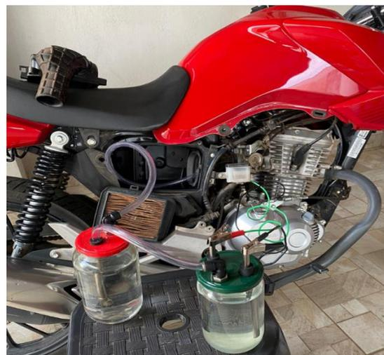
**Figura 8** – Gerador de hidrogênio e borbulhador acoplado ao veículo teste.
