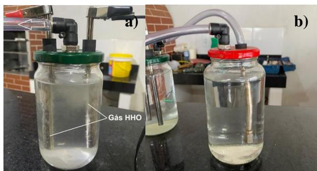
**Figura 7** - Processos com o protótipo: (a) Teste com o gerador de hidrogênio, (b) Borbulhador.
