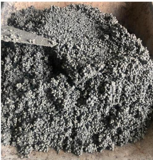
**Figura 2** – Mistura do concreto com EPS em pérolas
