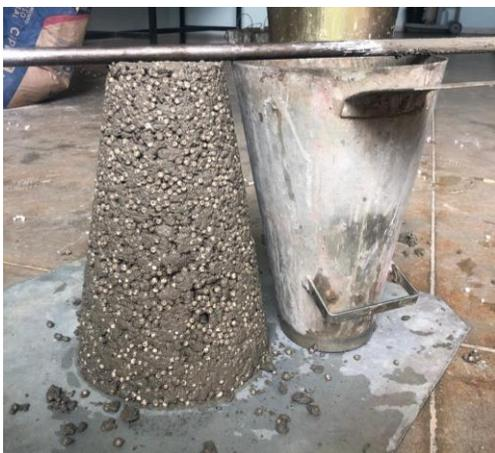
**Figura 3** – Slump Test (Ensaio de Abatimento)
