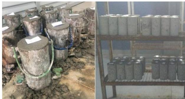
**Figura 4** – (a) Moldagem dos corpos de prova; (b) Corpos de prova em câmara úmida.
