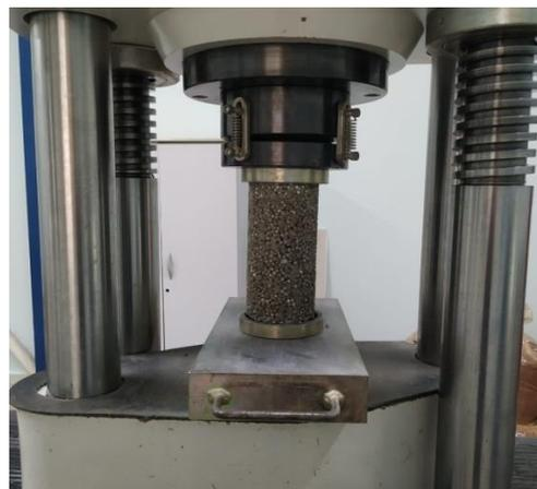
**Figura 5** – Corpo de prova na prensa
