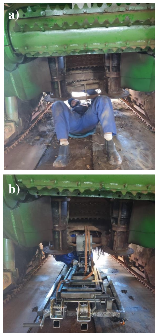
Figura 13 – Manutenção dos rolos de colhedora a) sem o uso do braço mecânico, e b) com o uso do braço mecânico.
