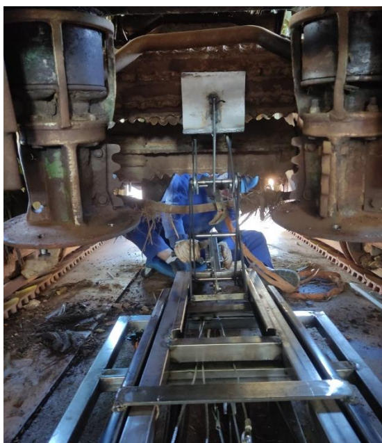
Figura 15 - Teste do braço mecânico no rolo sujo.
