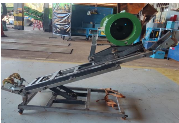
Figura 14 - Teste do braço mecânico no rolo limpo.
