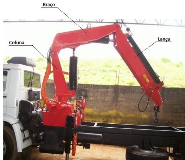
Figura 4 – Braço mecânico hidráulico utilizado em caminhão Muncie. [12].
