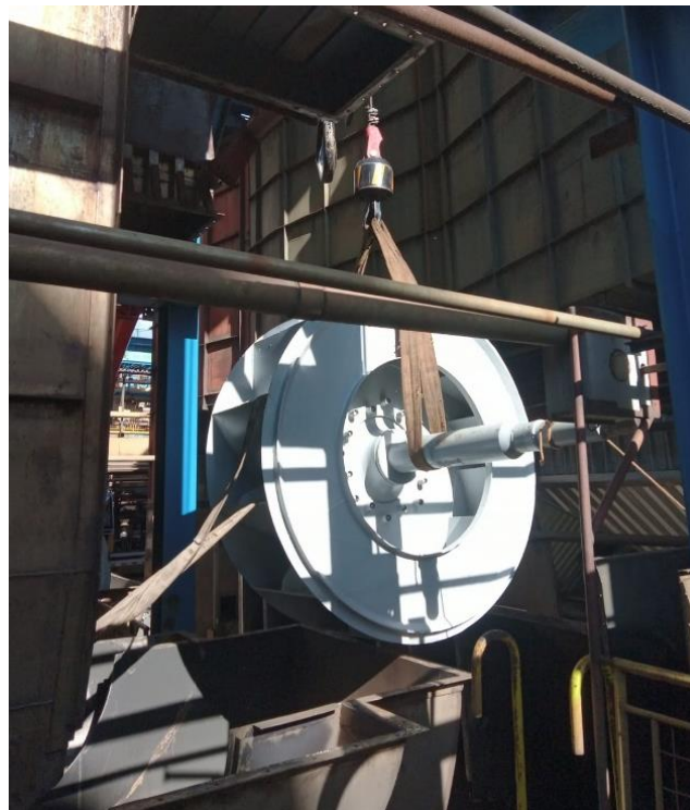
Figura 7 – Rotor estudado sendo içado para ser acoplado ao exaustor.
