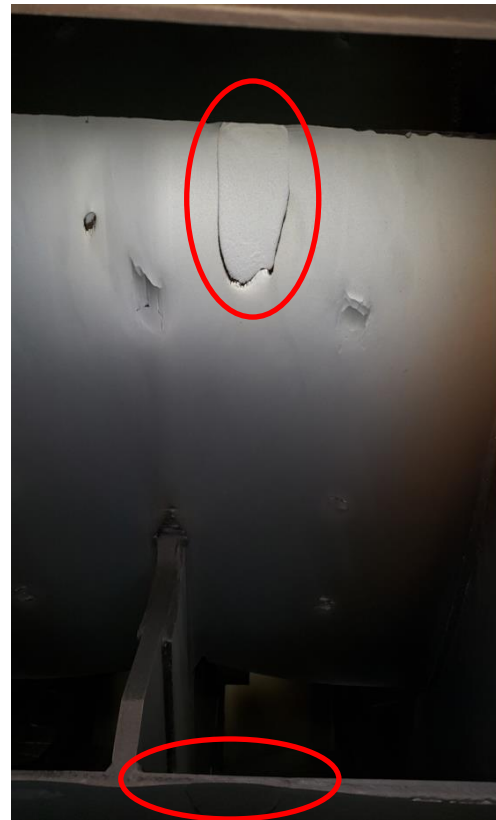
Figura 12 – Desgaste observado nas pás do rotor, após aumento brusco da vibração.
