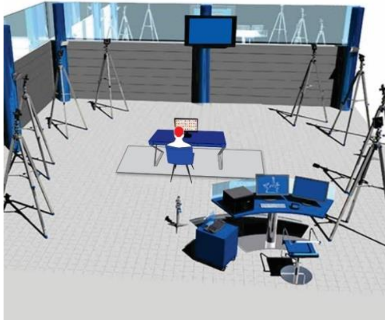
Figura 5. Colocação de marcadores para análise tridimensional usando o SMARTUp: a configuração experimental.
