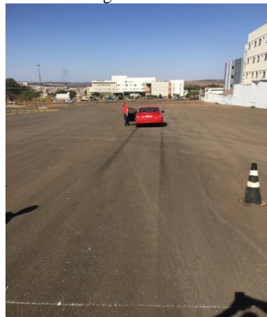
Figura 13 – Marca da frenagem em um veículo sem sistema ABS
