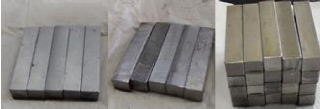
Figura 3: Corpos-de-prova normal, forjados e normalizado/recozidos.
