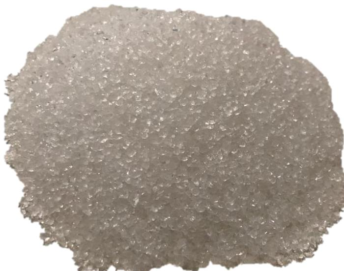
Figura 1 – Par adsorvente - sílica-gel branca com grãos de 0,5 a 1,5 mm de diâmetro. Fonte: fonte própria
