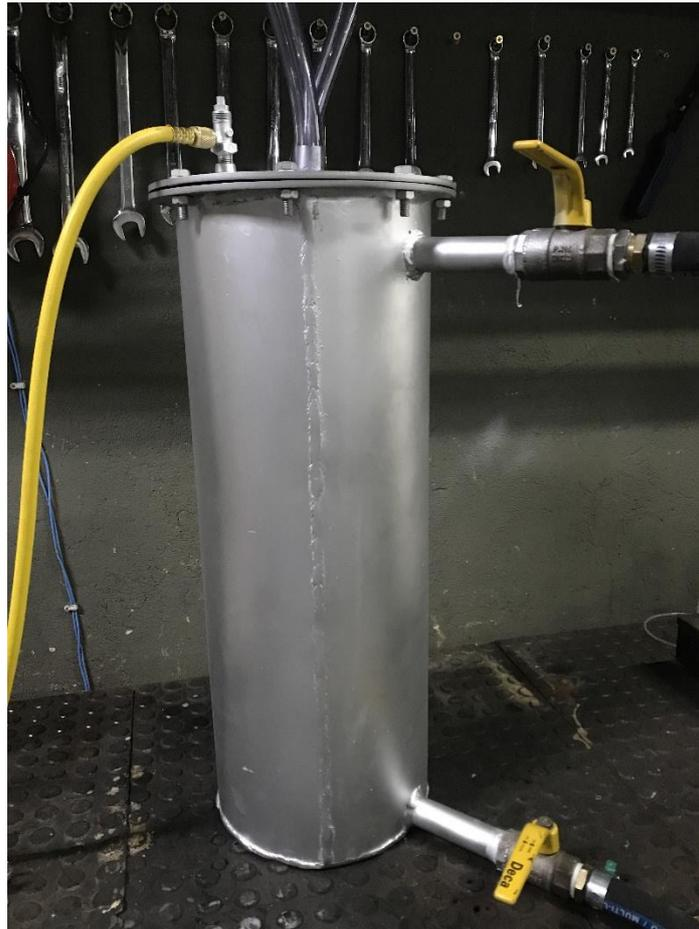
**Figura 7** – Protótipo de chiller adsortivo finalizado. Fonte: fonte própria
