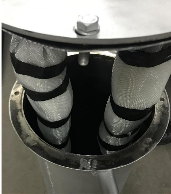
**Figura 8** – Trocador de calor preenchido com adsorvente envolvido por tela. Fonte: fonte própria
