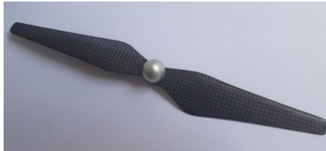
Fotografia 2: Hélices de fibra de carbono modelo Phantom
