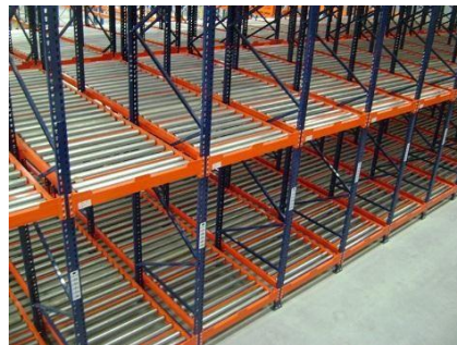
Figura 1: Sistema Push Back
