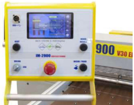
Imagem 8: Painel de controle da Seccionadora
