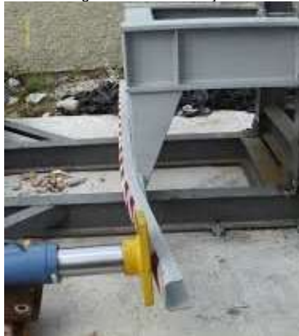
Figura 6 – Carregamento e deformação lateral de um ensaio físico real
