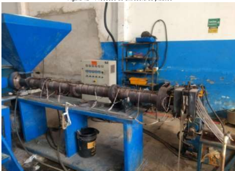
Figura 12 – Processo de extrusora de plástico
