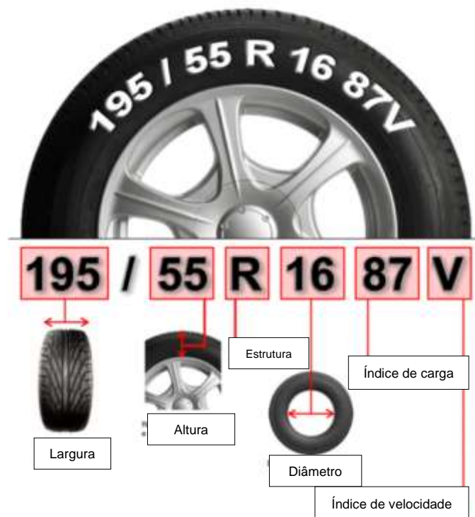
Figura 8: Leitura da marcação de pneus
