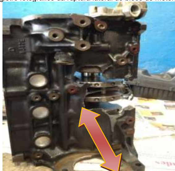
Figura 18: Registro fotográfico da ruptura lateral do bloco do motor, em vista lateral
