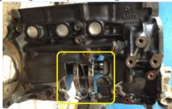
Figura 16: Registro fotográfico da ruptura lateral longitudinal do bloco do motor, em vista lateral.
