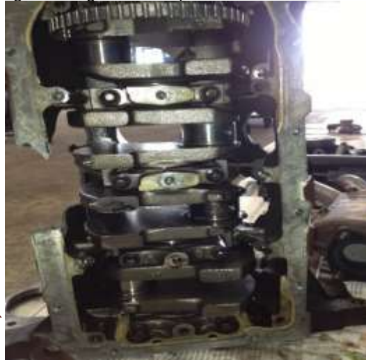
Figura 17: Registro fotográfico da ruptura lateral do bloco do motor, em vista inferior.
