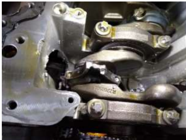
Figura 7: Biela fraturada, e a quebra do bloco do motor por esse motivo.
