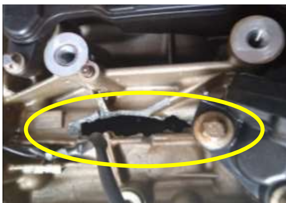
Figura5: bloco do motor apresentando um furo lateral provocado pela soltura da biela do cilindro
