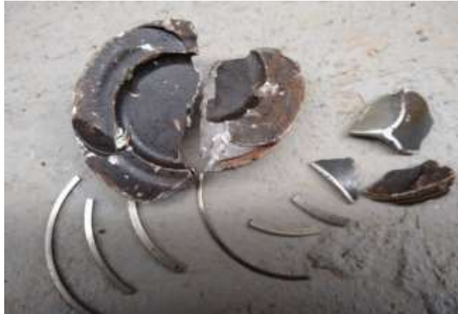
Figura 6: Pistão e anéis danificados
