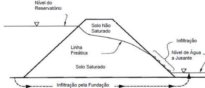
Figura 7 - Esquema de infiltração em uma barragem
