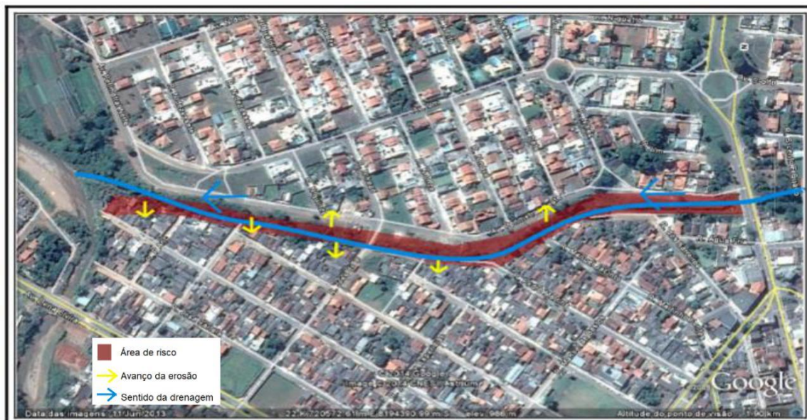
Figura 03 – Área de risco à movimentação de massa e enchentes
