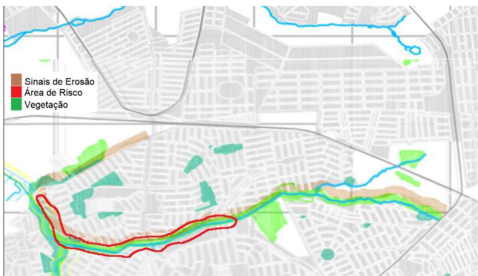
Figura 02 – Condições da planície do Córrego Água Fria
